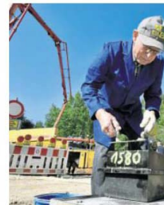
Max Wutz füllt etwas Beton in Würfel-Formen für einen Test. Bild: Stephan Huber
